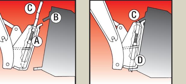
Da esquerda para a direita o passo-a-passo do sistema Bob-Tach: O quadro Bob-Tach (A) se encaixa na flange do acessório (B). A alavanca (C) dobra com facilidade para baixar o pino que trava o acessório na posição correta (D) para um encaixe firme e seguro.
