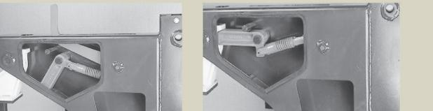
Além do sistema Bob-Tach, os acessórios de retroescavadeiras Bobcat® utilizam encaixes com ganchos que se fixam na minicarregadeira para proporcionar maior firmeza ao acessório. Uma alavanca em cada braço da retroescavadeira aciona um pino que se encaixa diretamente nos olhos da máquina.
