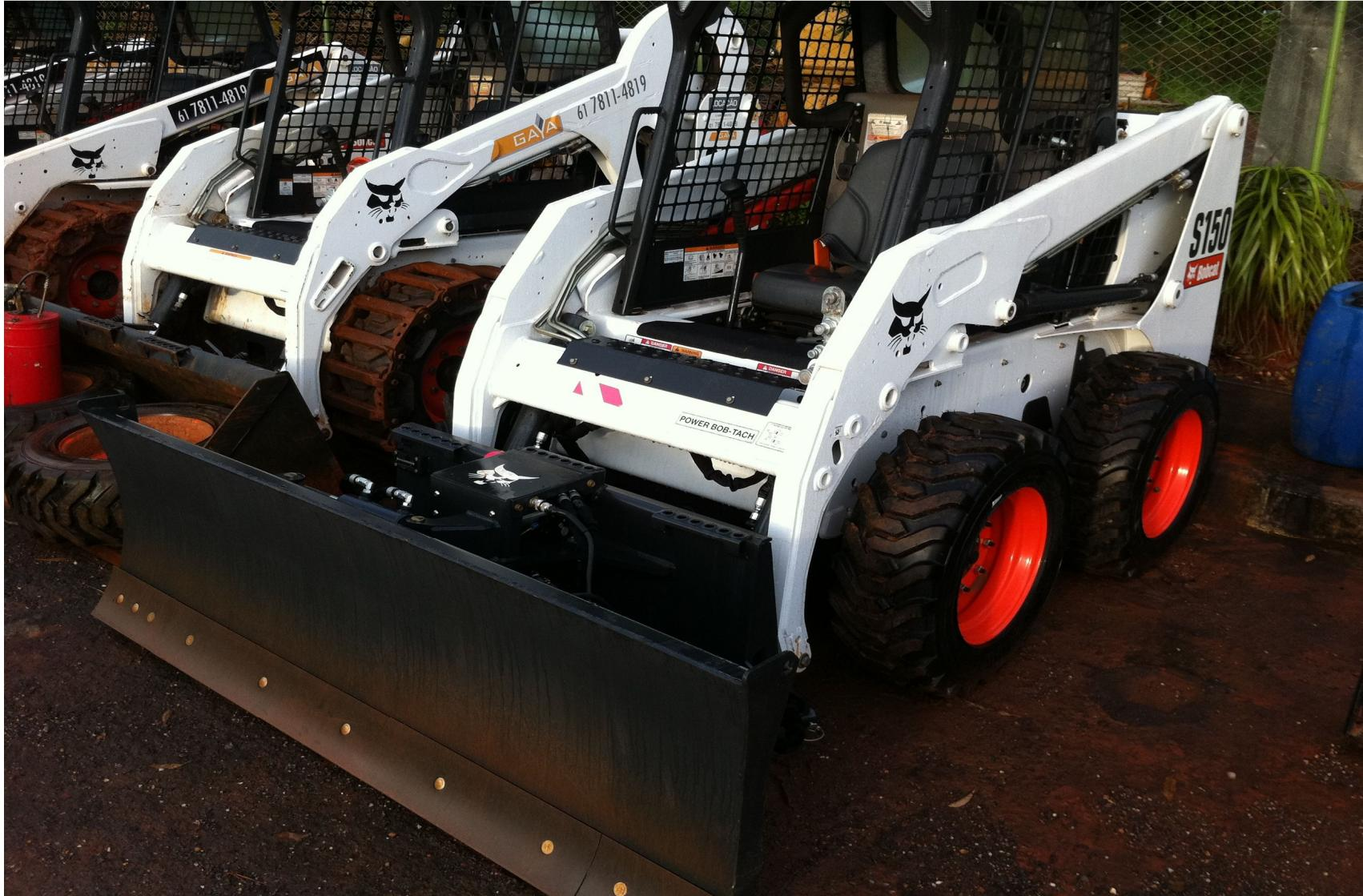
A lâmina dozer transforma sua Bobcat em uma mini-motoniveladora.
