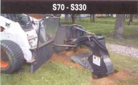
Use os dentes de metal duro deste poderoso acessório para acabar com os incômodos tocos de árvores.
