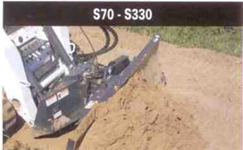
A lâmina dozer transforma sua Bobcat em uma mini-motoniveladora.
