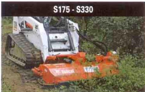
Limpa o mato alto e árvores de diâmetro de até 7 centímetros.
