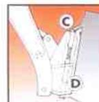
Para trocas rápidas e seguras. O quadro Bob-Tach (A) se encaixa dentro da flange (B); a alavanca (C) é virada para baixo, travando o pino de segurança (D) pela abertura do quadro para uma conexão sólida.
